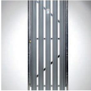
Türen im Mauerwerk 180 Grad öffnend, aushängesichere Bänder (2-tlg.), vorgerichtet für Vorhängeschloss, lichte Durchgangsbreite 1.125 mm, Standardsystemhöhe 1.900/2.050/2.250 mm. Alle Stahlteile feuerverzinkt.
