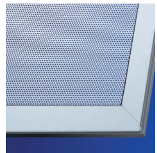
■ Variante RV Füllung aus Aluminium Rundlochblech RV 5/8, E6/EV1 eloxiert
